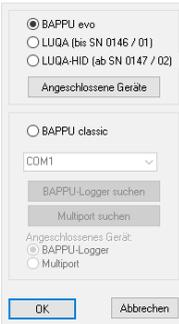
Beim Konfigurationsfenster handelt es sich um das Hauptfenster zum Einstellen von Messvorgaben und Konfigurationsdaten. Wählen Sie zum Öffnen des Fensters in der Menüleiste „Logger/konfigurieren“.
