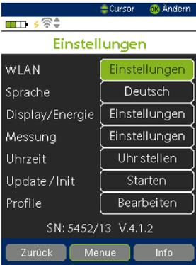
Hier kann die WLAN Funktion durch drücken der Taste
